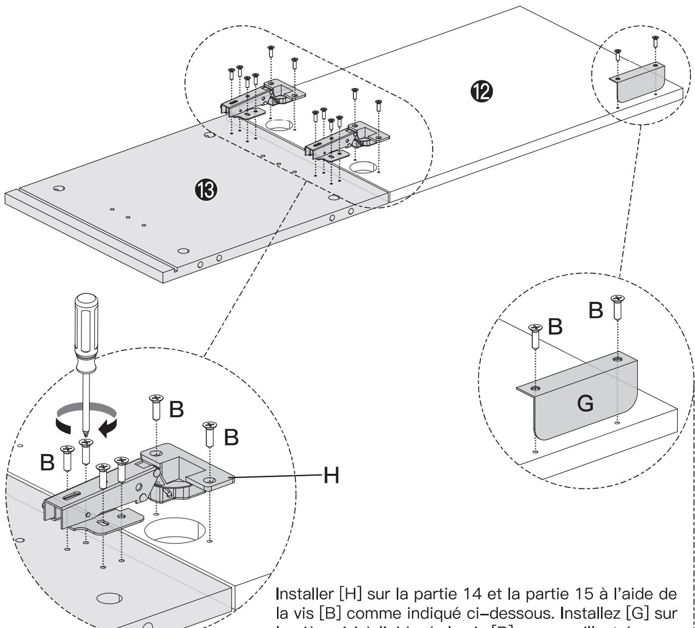
Installer [H] sur la partie 14 et la partie 15 à l'aide de la vis [B] comme indiqué ci-dessous. Installez [G] sur la pièce 14 à l'aide de la vis [B], comme illustré. Serrez avec un tournevis Phillips.
