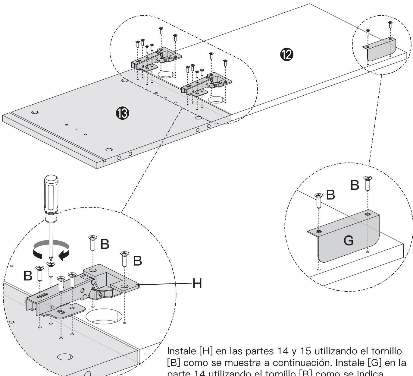
Instale [H] en las partes 14 y 15 utilizando el tornillo [B] como se muestra a continuación. Instale [G] en la parte 14 utilizando el tornillo [B] como se indica. Ajuste con el destornillador Phillips.
