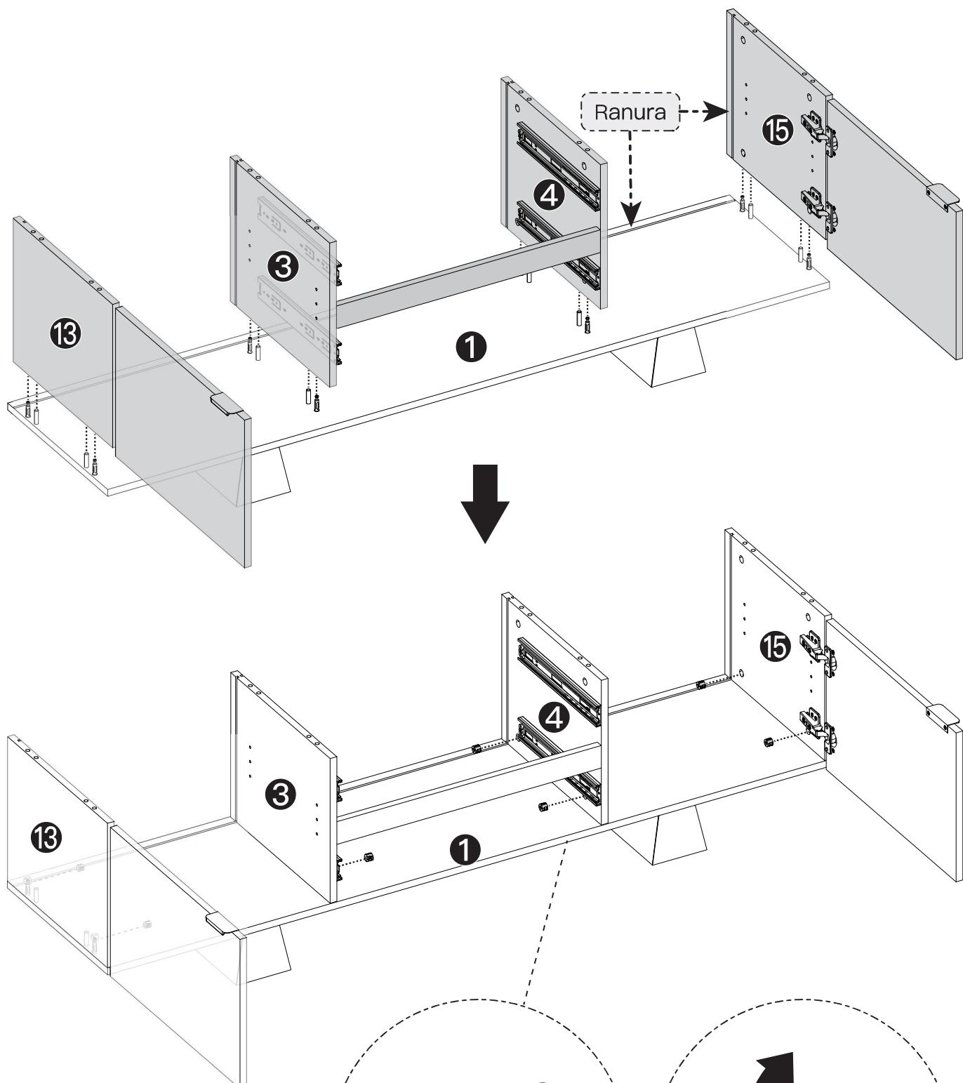
Inserte [F] en las partes 3, 4, 13 y 15 como se muestra a continuación. Apriete con el destornillador Phillips.
