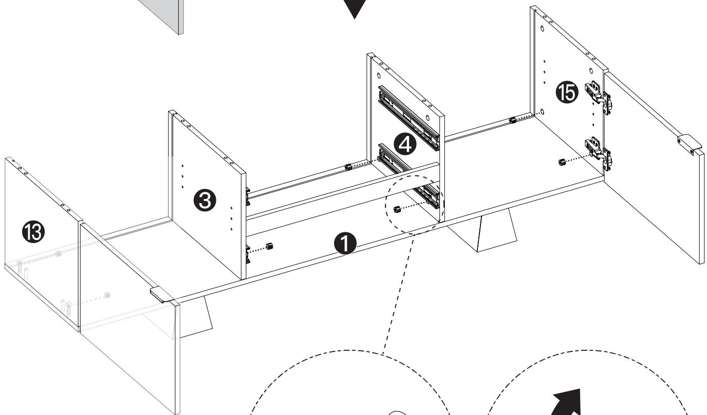
Insérez [F] dans la partie 3, la partie 4, la partie 13 et la partie 15 comme indiqué ci-dessous. Serrez avec un tournevis Phillips.
