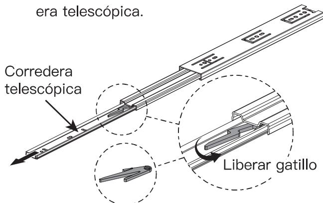
3-4 Separe la corredera telescópica de su ensamblado.
